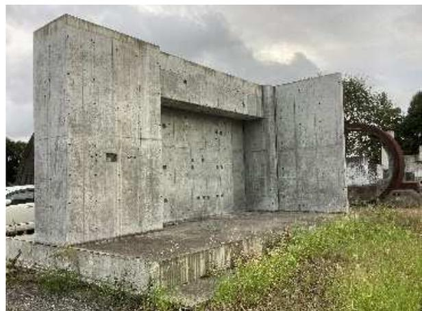
写真 2.10 母材 (高強度 100N/mm<sup>2</sup>)
